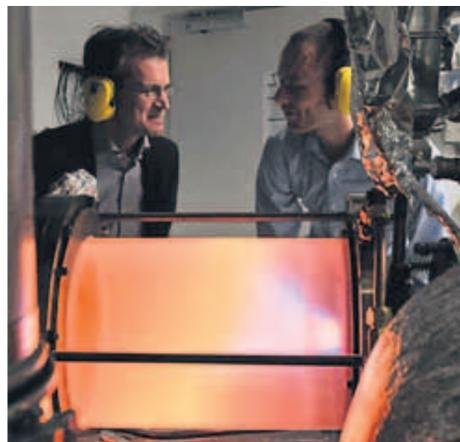
Heiße Sache. Oliver Paschereit (li.) und sein Kollege Sebastian Göke bei einem Test der nassen Verbrennung. Dabei wird dem Brennstoff zusätzlich Wasserdampf hinzugefügt, um die Effizienz von Turbinen zu erhöhen. Foto: TU Presse/Dahl
